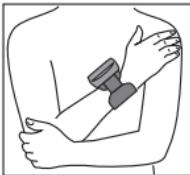
Doğru ölçüm için bütün tansiyon ölçerler kalp seviyesinde pozisyonlandırılmalıdır. Örnek: Eğer alet, solda görüldüğü gibi kalp seviyesinden 20 cm aşağıda pozisyonlandırılırsa (mesela kolumnuzu masanın üzerine koyarak), elde edeceğiniz ölçüm yaklaşık olarak 15 mmHg yüksektir.
